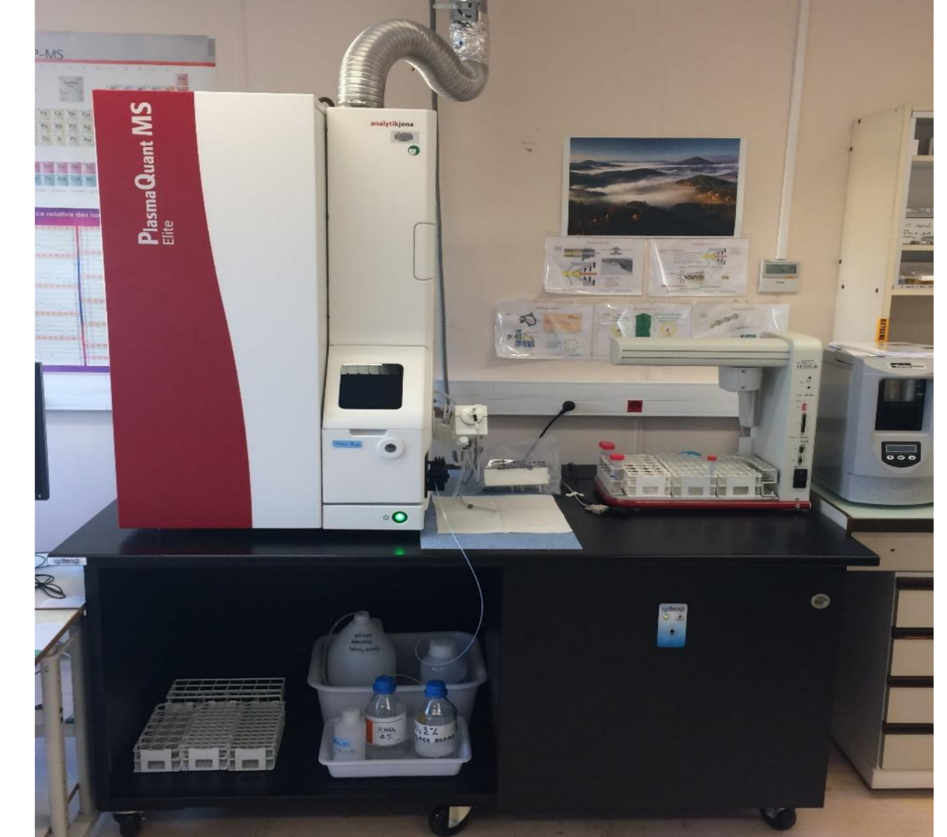
Figure 1 : appareil ICP-MS Analytik Jena PQMS Elite au LARC
