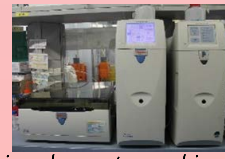
Chaine chromatographique pour l'analyse des anions et cations
