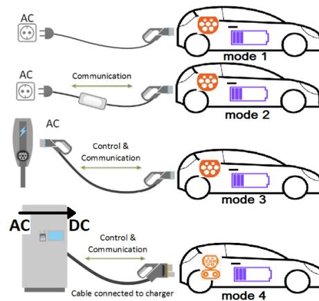
Figure 11 : Modes de charge des véhicules électriques
