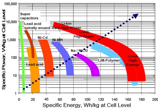
Figure 1 : Diagramme de Ragone supercondensateur et accumulateurs électrochimiques
