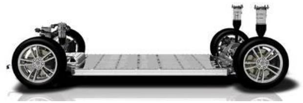
Figure 6 : Pack batterie de véhicule TESLA intégré dans le plancher [6]
