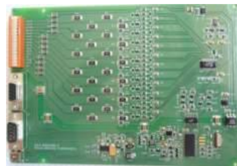
Figure 3 : Carte de surveillance et d'équilibrage d'un module de batterie Lithium-ion
