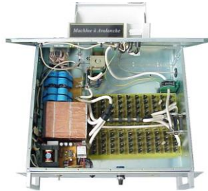
Figure 2 : Banc de test en avalanche à courant constant
