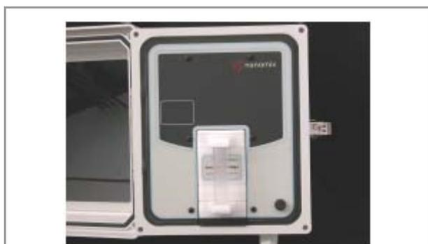
Figure 23 : Le prototype pré-production de Nanomix pour la détection de  $\text{NH}_3$  en milieu avicole.
