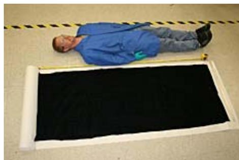
Figure 27 : Film de très grande surface à base de nanotubes dont la faisabilité a fait l'objet d'un communiqué de presse de la part de la société Nanocomp technologies. On notera la présence d'un employé seulement muni d'une blouse et d'une paire de gant au voisinage immédiat du film.
