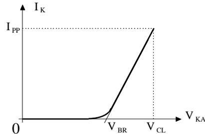
**Figure 12 :** caractéristique inverse typique d'un écrêteur
