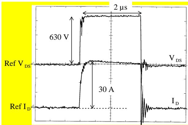
**Figure 9 :** Oscillogramme de l'écrêtage intrinsèque d'un MOS 500 V
