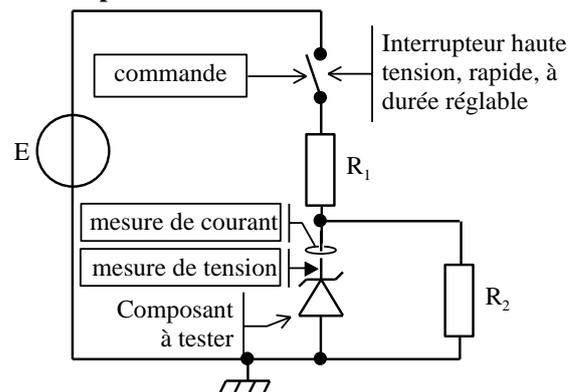
Figure 3 : schéma de la Machine à Avalanche
