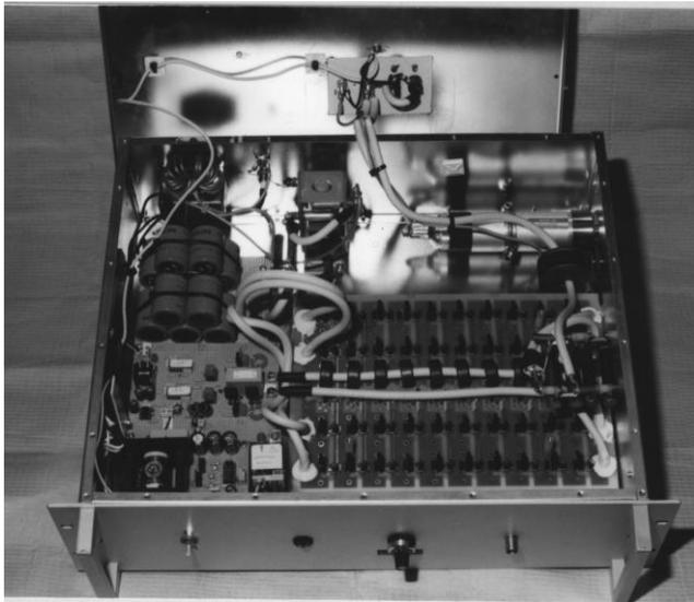
Figure 7 : photographie de la Machine à Avalanche ouverte
