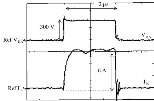
Figure 8 : Oscillogramme de l'écrtage d'une diode BYW 100 200
