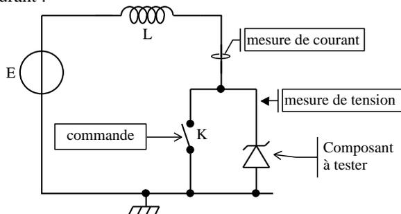
Figure 1 : schéma de test utilisant l'ouverture sur une source de courant
