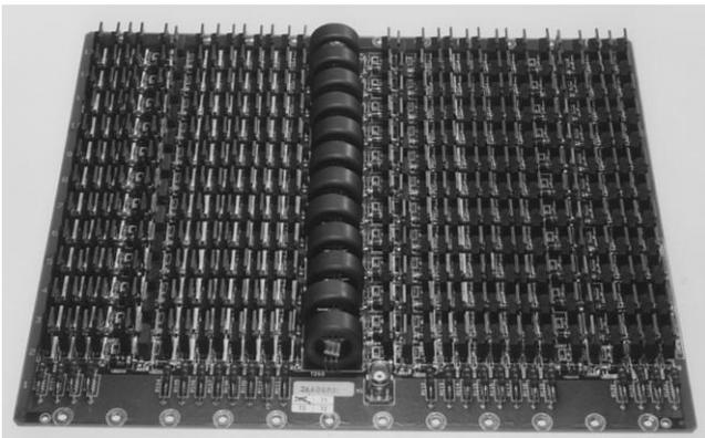
Figure 2 : Carte interrupteur 5 kV, 800 A, de 350 MOS
