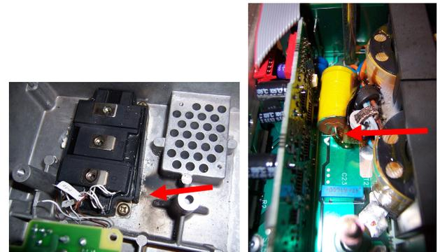
Figure 7 : module IGBT explosé. Figure 8 : condensateur polypropylène ayant surchauffé jusqu'à sa destruction.
