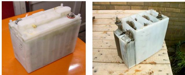
Figure 1 et 2 : vues d'un module de batterie Ni-Cd.
