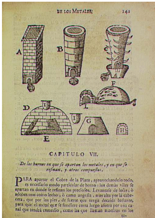
La représentation d'une huayrachina (en haut à droite), d'après Barba (1640, p. 141)
