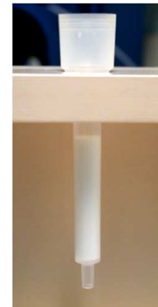
Colonne 2 mL Capacité = 3 mg Ni
