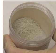
Boues immobilisées dans des bétons
