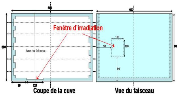
FIGURE 1.3 – Représentation de la cuve à eau en PMMA de  $60 \times 30 \times 30 \text{ cm}^3$  utilisée pour les mesures et les simulations.
