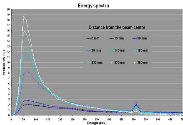
FIGURE 1.7 – Spectres en énergie des photons à différentes distances du centre du champ.
