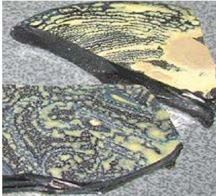
Verre hétérogène par la cristallisation de phases molybdates ( $\text{CaMoO}_4$  &  $\text{Na}_2\text{MoO}_4$ )
