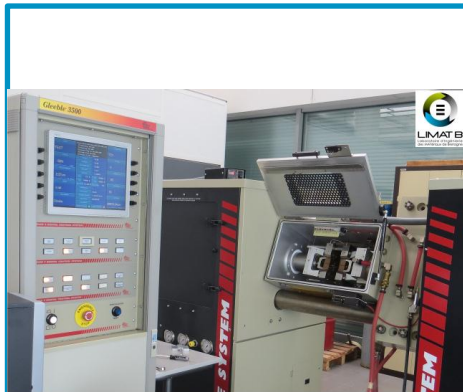
Caractérisation du comportement sur machine Gleeble au LIMAT'B
