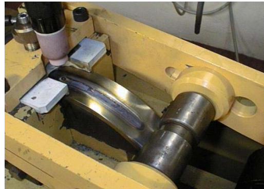
Essais trapézoïdaux, Varestreint et oblique au LTA
