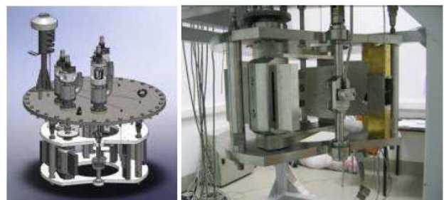
Fig. 23. MULTIREFLECTEUR mockup for telemetry sodium tests.
