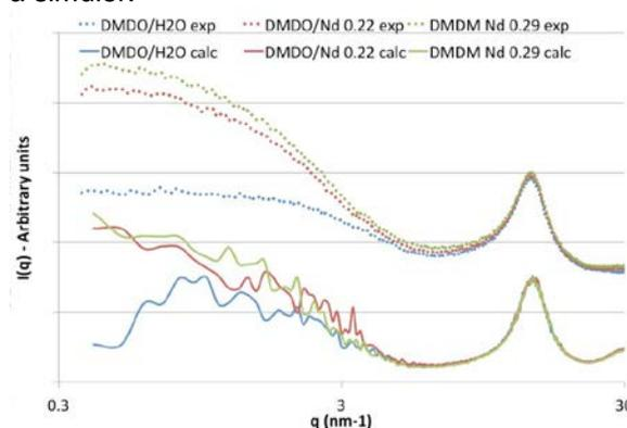
**Fig. 1.** Intensités diffusées aux petits et moyens angles expérimentales (pointillés) et calculées (traits pleins) pour des solutions de DMDOHEMA après extraction d'eau (bleu), ou de Néodyme(III) à deux concentrations (rouge et vert)
