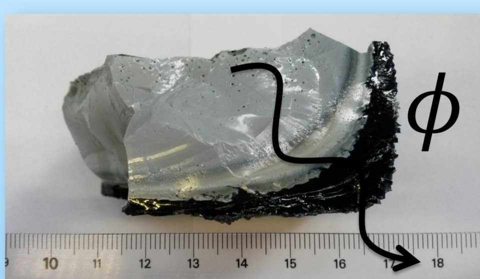
Reliquat de verre issu d'une fonte en creuset froid, au contact du creuset refroidi
