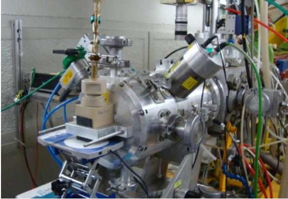
Cellule d'irradiation \alpha positionnée sur la ligne de faisceau du cyclotron CEMHTI (Orléans)
