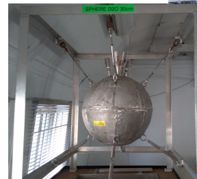
Sphère d'eau lourde pour la modulation du spectre de ^{252}\text{Cf}
