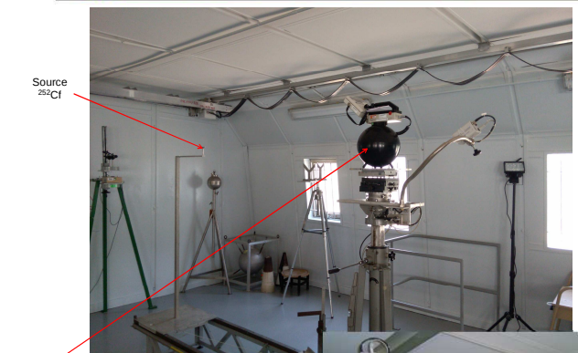
Étalonnage dans le champ de référence neutronique
