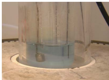
LiCl-KCl-PuCl 3 , Bi electrode at 500°C
