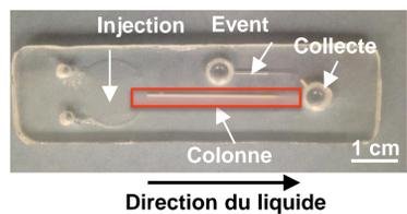
Microsystème chromatographique centrifuge en polymère thermoformable (Copolymère d'Oléfines Cycliques)
