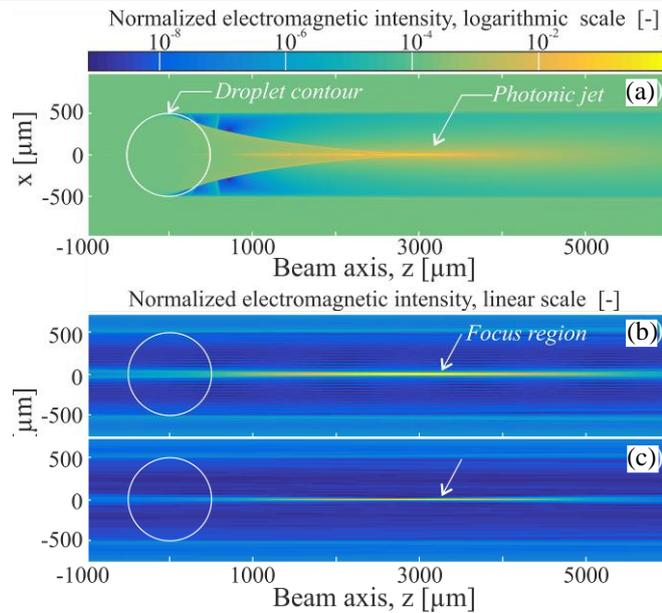
Figure 2 : Intensité du champ proche électromagnétique - (a) calcul direct avec la TLM; Reconstructions avec la THFG lorsque l'hologramme est ; (b) généré avec la TLM ; et (c) enregistré expérimentalement (seulement une propagation inverse). Le cercle blanc délimite le contour de la particule.
