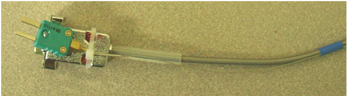
Figure 16 : Prise RS232 et la gaine ressort pour protéger les 6 fils TC de 25 \mu m
