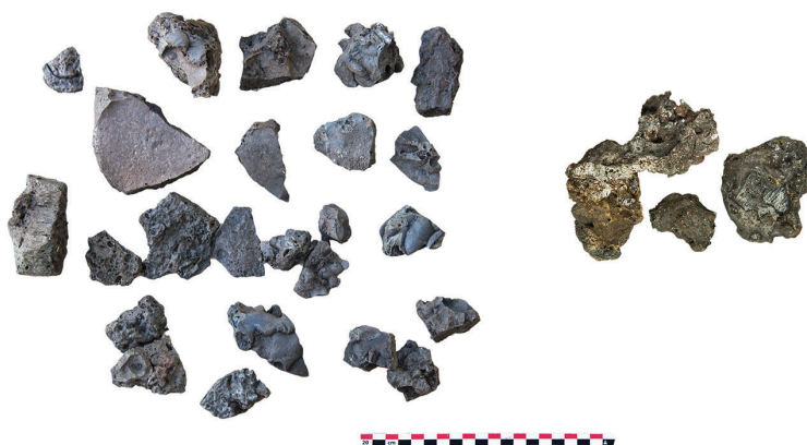
FIGURE 4 – Lot de fragments de scories coulées denses prélevées dans le ferrier de l'Oratori (Canigou, Pyrénées-Orientales) (photographie de gauche) et scories de forge (Castel-Minier, Ariège) (photographie de droite).
