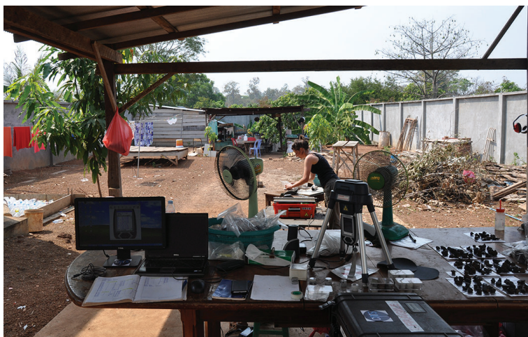
FIGURE 5 – Découpe, polissage et mesure des échantillons avec pilotage déporté de la pXRF (Phnom Dek, Cambodge).
