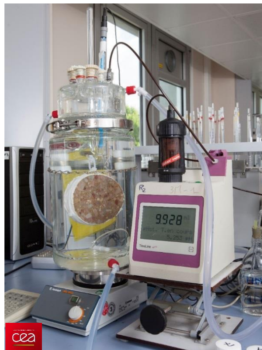
Essai de dégradation chimique d'un béton en laboratoire
