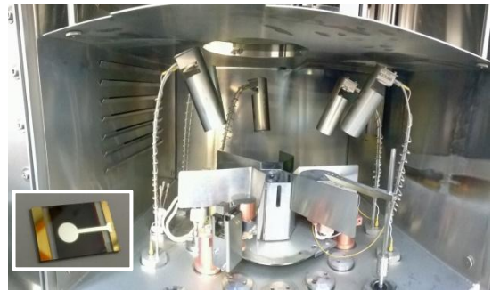
Figure 1 – Chambre du réacteur multi-sources MBRAUN utilisé et photo d'un dispositif PV réalisé (insert)
