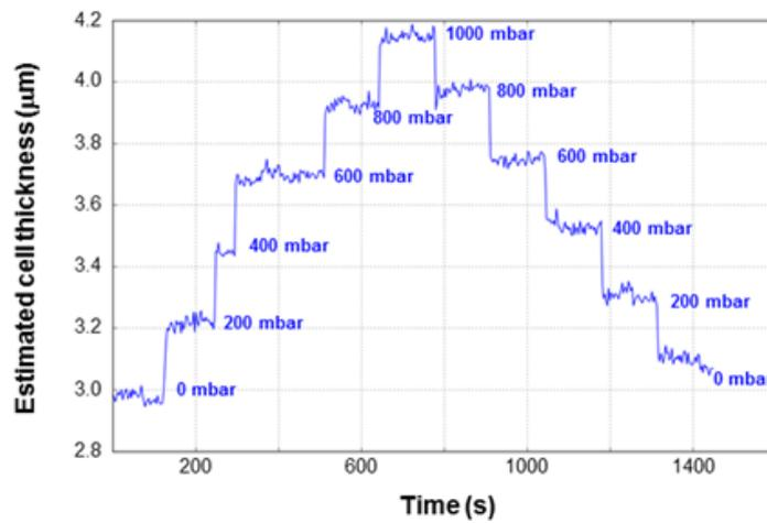
Figure 2. Variation de l'épaisseur apparente de la cellule (déformation de la membrane de SiN) en fonction de la pression utilisée pour l'actuation du fluide.
