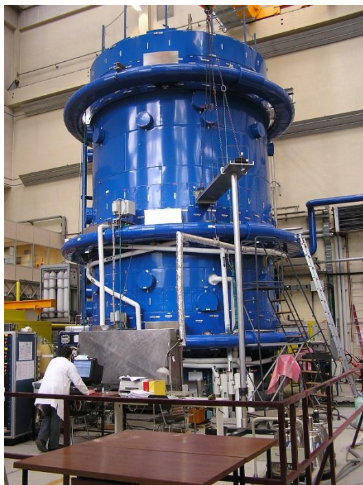
Figure 1 : MISTRA Simulateur expérimental de l'enceinte de confinement d'un réacteur nucléaire pour l'étude de la dispersion de l'hydrogène
