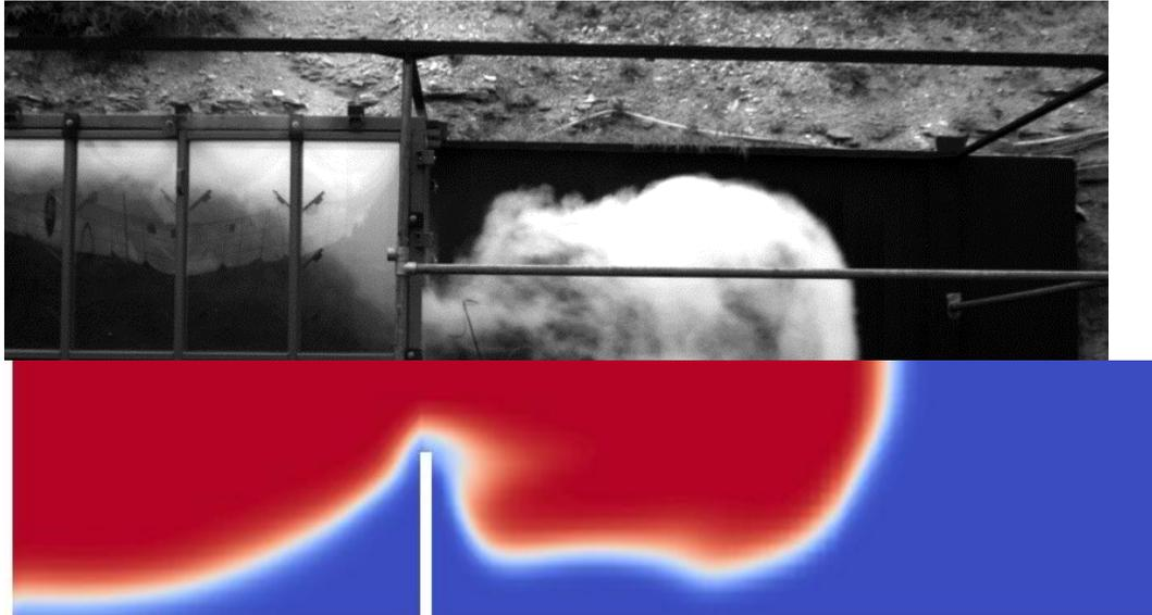
Figure 4 : ANR/DIMITRHY : Comparaison Expérience/Simulation avec EUROPLEXUS pour une explosion hydrogène avec un événement. Valorisation des recherches pour la filière hydrogène-énergie.
