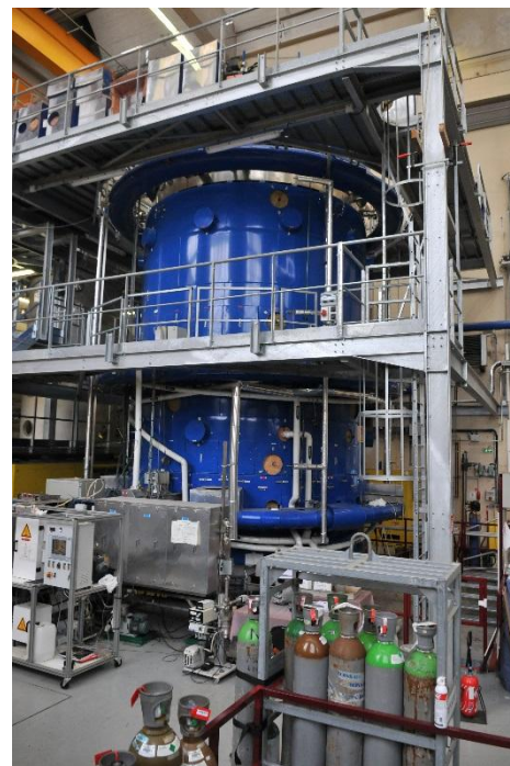
Figure 1 : MISTRA Simulateur expérimental de l'enceinte de confinement d'un réacteur nucléaire pour l'étude de la dispersion de l'hydrogène
