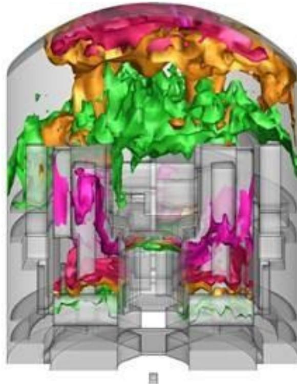
Figure 2 : Calcul TONUS pour EPR : nuages inflammables à 4% d' $H_2$  (vert – limite d'inflammabilité), 8% (orange – flamme tridimensionnelle), 11% (rouge – limite d'une possible forte accélération) et 18% (violet – limite d'une possible détonation)
