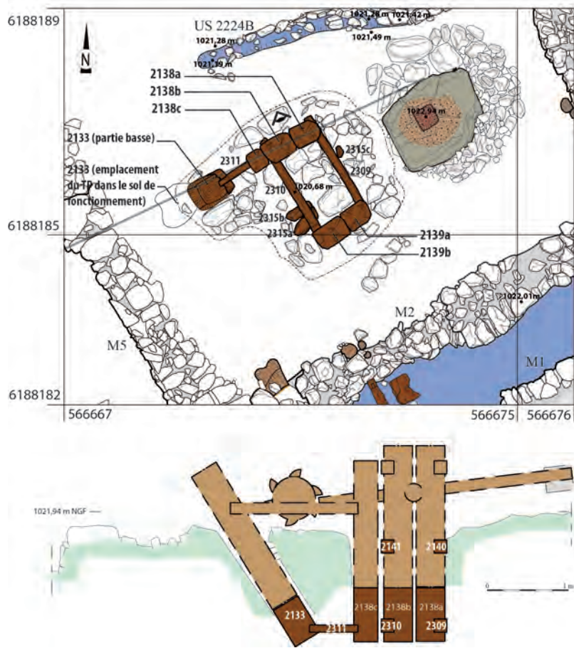
Fig. 5 - La soucherie du marteau hydraulique
