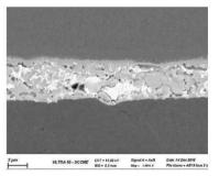
Essais réalisés avec : T=18,5°C 3 ppm HCl, faible RH 33% 2 temps : 168h et 2 mois
