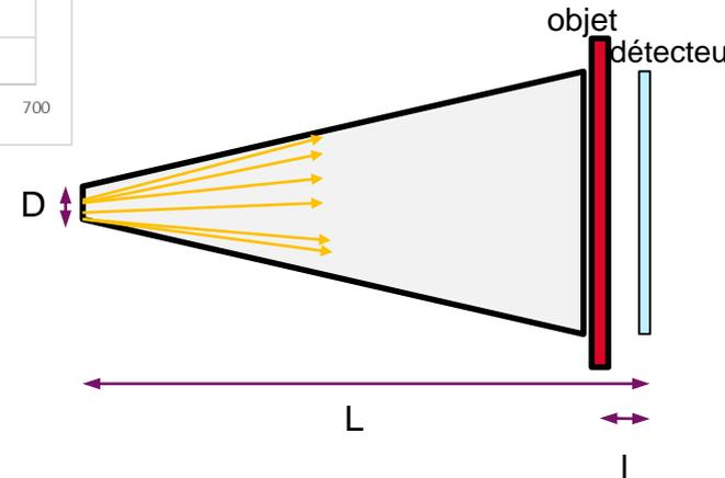
Un gain en sensibilité d'un facteur 5 du détecteur permet un gain d'un facteur 2 sur le flou géométrique, via la réduction de D
