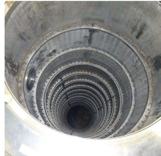
Décontamination : par attaque des couches superficielles les plus contaminées
