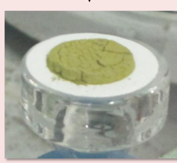
Gâteau de peroxyde de Pu lavé et séché partiellement
