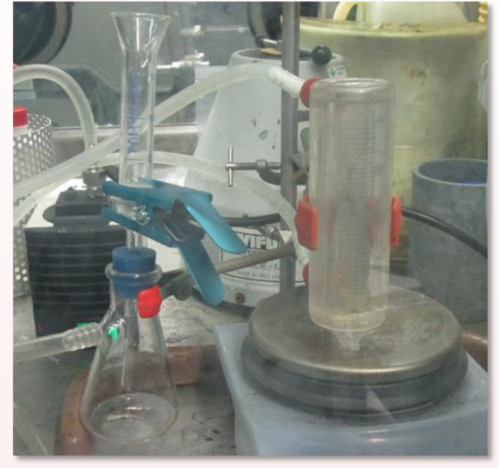
Réacteur double-enveloppe thermostaté avec agitateur magnétique et fritté
