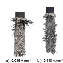
Figure 6 : Cathode après électrolyses dans LiF-NaF-ZrF<sub>4</sub> (m<sub>0</sub> = 1,96 mol.kg<sup>-1</sup>) à 750 °C à différentes densités de courant
