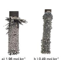
Figure 7 : Cathodes après électrolyses à -35 mA.cm<sup>2</sup> dans LiF-NaF-ZrF<sub>4</sub> à différentes concentrations à 750 °C
