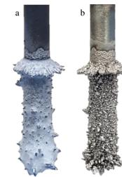
Figure 4 : Photo d'une cathode (a) avant et (b) après nettoyage aux ultrasons
