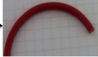
Dégradation du joint de polydiméthylsiloxane réticulé (PDMS) dans un bain de sodium à 200°C
