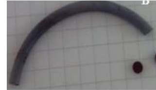
Dégradation du joint de polydiméthylsiloxane réticulé (PDMS) dans un bain de sodium à 200°C
