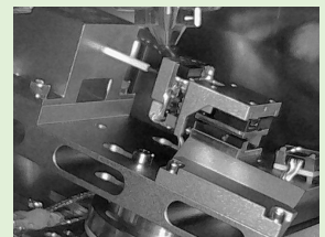
Photographie du nanoindenteur dans la chambre du MEB
