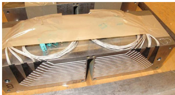
Fig. 1. Bloc de la maquette instrumentée en thermocouple (avant réassemblage) [2].
