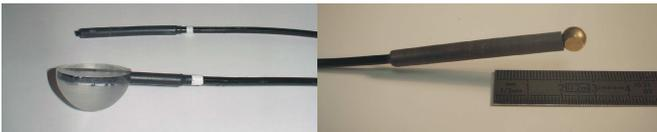
Fig. 2. CFO OSL solidarisés en extrémité de cordon optique (capteur nu, avec capuchons en PMMA (en bas, à gauche) et en laiton (à droite))
