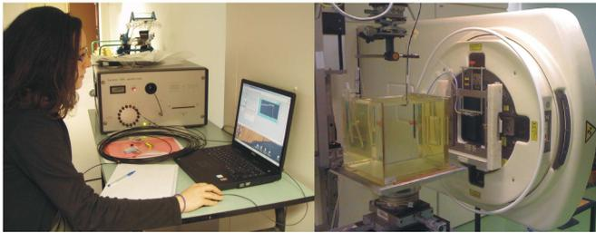
Fig. 1. Dosimètre OSL multivoies (gauche) développé par le CEA LIST dans le cadre du projet Européen MAESTRO et irradiation d'un CFO OSL en conditions de référence au CEA LIST LNHB (droite)
