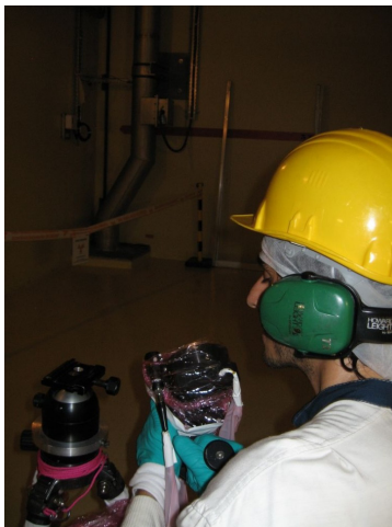
Figure 9.1 – Observation du point chaud par l'opérateur, caméra tenue en main. Hot spot observation with the camera handled.
