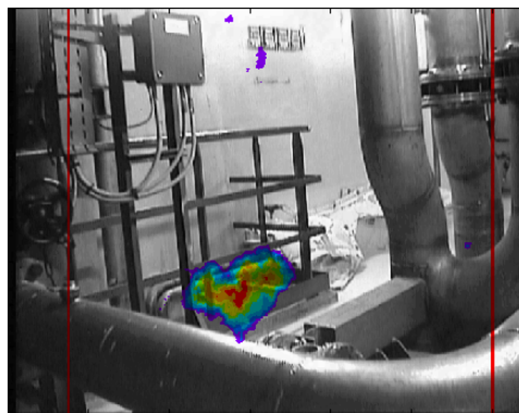
Figure 8.2 – Image caméra gamma de la scène sur 2 \times 120 s : la partie de la tuyauterie non blindée est clairement identifiée.
