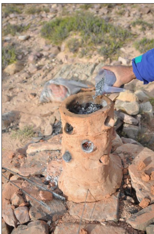
Figura 6. Carga de mineral en la wayra 2.
