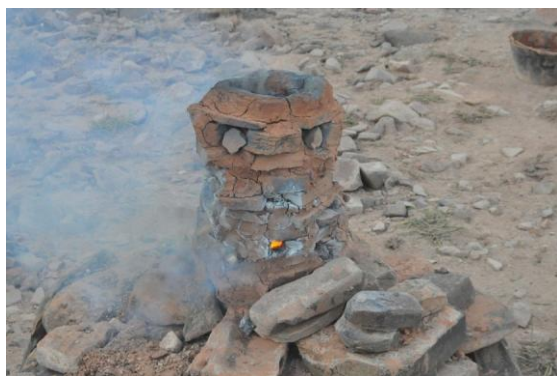
Figura 9. Wayra de piedra (W5) en funcionamiento.
