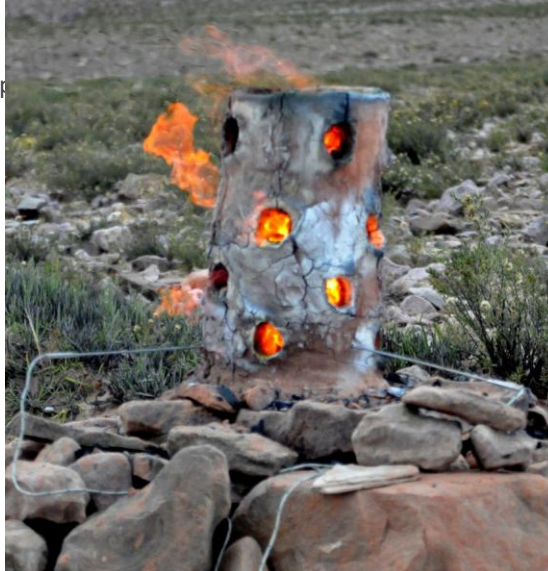
Figura 11. Wayra 7 en funcionamiento con las sondas termocuplas insertadas.
