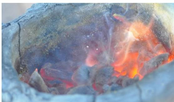
Figura 10. Formación de plomo en el borde de la columna de reducción de la wayra 6
