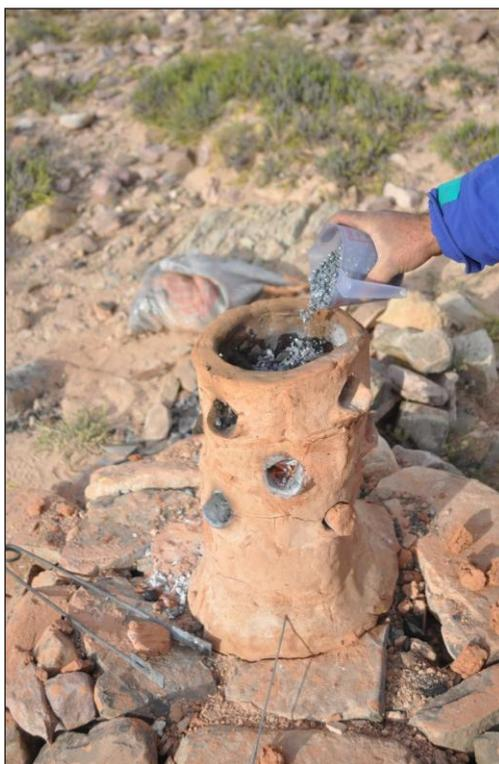
Figura 6. Carga de mineral en la wayra 2.
