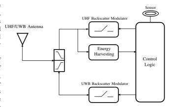
Fig. 9. Hybrid UHF-UWB tag.
