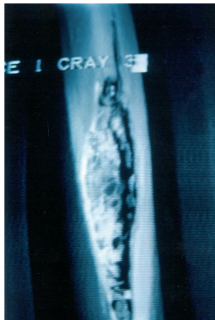
Fig. 21. Défaut d'étanchéité créé par hydruration.
