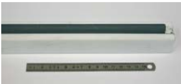
Fig. 163. Vue d'un barreau de carbure de tungstène élaboré par extrusion.
