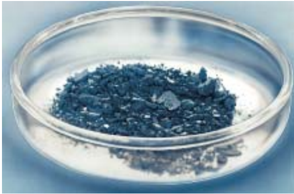
Fig. 37. Dépôts de Mo-Zr prélevés sur un dissolvant de l'usine UP3 de La Hague.
