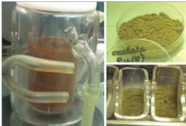
Fig. 65. Essai de conversion oxalique du Pu(IV) en oxyde à l'échelle laboratoire ; à gauche : le réacteur de précipitation à effet vortex ; à droite et en haut : le précipité oxalate lavé ; à droite et en bas : le produit de la conversion \text{PuO}_2 après calcination.
