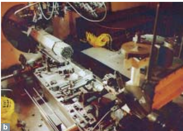
Fig. 90. (a) Découpe par meulage du tube hexagonal. (b) Retrait mécanique unitaire des aiguilles du tube tronçonné.
