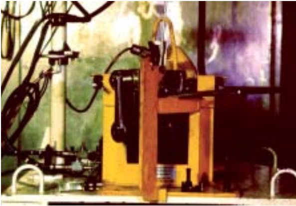
Fig. 92. Cisailage unitaire des aiguilles de combustible (Atelier Pilote de Marcoule).
