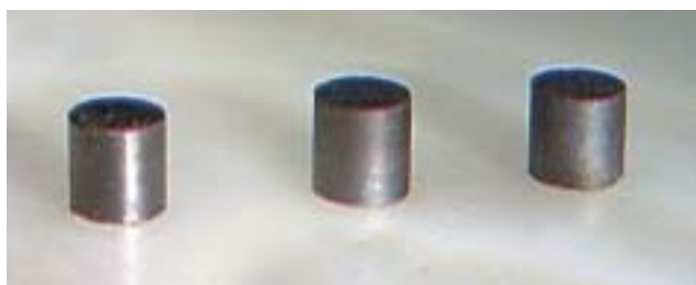
Fig. 159. Pastilles d'oxyde mixte \text{UPuO}_2 incorporant de l'américium, du neptunium et du curium.
