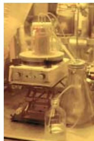
Fig. 149. Coconversion Pu(IV)-Am(III) en oxyde dans l'installation ATALANTE.
