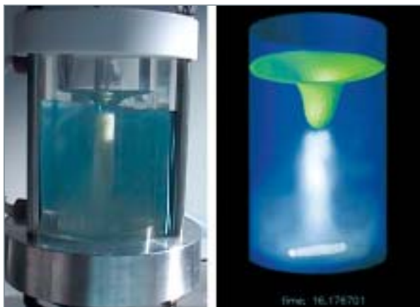
Fig. 67. À gauche : premiers instants de la précipitation oxalique lors d'une injection de l'actinide dans le vortex forcé (Pu(IV) simulé par U(IV)) ; à droite : simulation de l'injection d'un traceur dans le vortex forcé [2].
