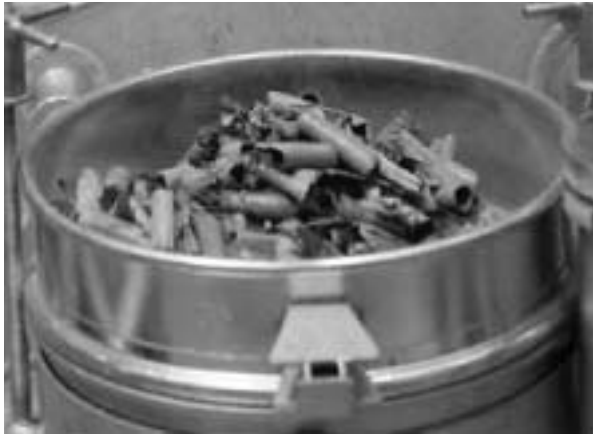
Fig. 30. Photographie des éléments métalliques récupérés à l'usine UP3 de La Hague après cisailage et dissolution d'un combustible REP-UOX.
