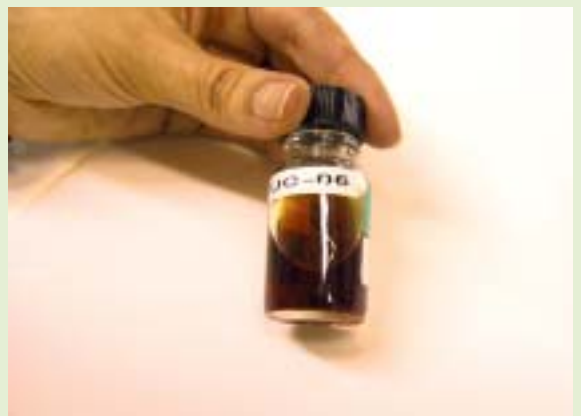
Fig. 97. Solution de dissolution de carbure d'uranium par l'acide nitrique concentré à ébullition, de composition finale [U] = 50g/l et [HNO_3] = 5M .
