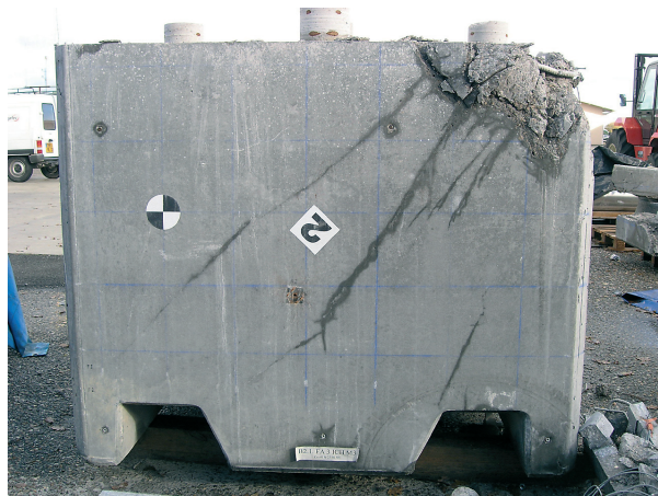
Fig. 73. Conteneur B2.1 après essai de chute et extraction de son couvercle.
