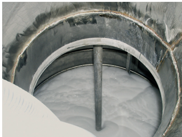
Fig. 7. Mousse de décontamination dans une cuve contaminée par des dépôts adhérents.
