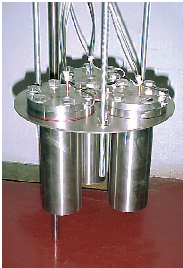
Fig. 79. Expérience « ERMITE » : ensemble de trois mini-conteneurs de 500 cm 3 remplis de matériau cimentaire avant introduction dans le dispositif d'irradiation.
