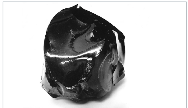
Fig. 19 a. Bloc de verre de confinement.
