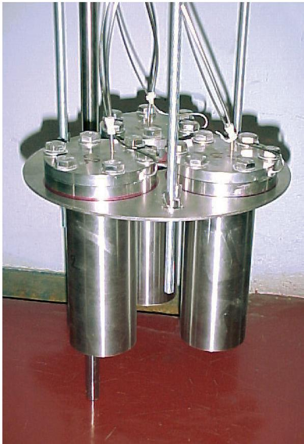
Fig. 79. Expérience « ERMITE » : ensemble de trois mini-conteneurs de 500 cm<sup>3</sup> remplis de matériau cimentaire avant introduction dans le dispositif d'irradiation.
