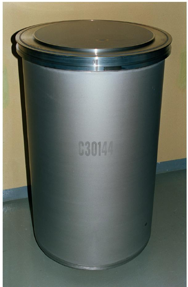
Fig. 97. Fût de tronçons de gaine et embouts cimentés.
