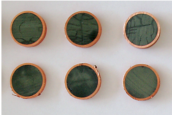
Fig. 110. Pastilles d'iodoapatite obtenues par compression isostatique à chaud, avec leur enveloppe de cuivre.
