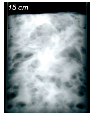
Fig. 88. Coupe radiographique par rayons X d'un enrobé bitume de synthèse soumis à une irradiation externe gamma d'environ 1MGy à 25 °C. Initialement, l'enrobé occupait la moitié de l'éprouvette expérimentale.
