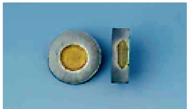
Fig. 109. Photo de pastilles tronçonnées ( \text{Pb}_{10}(\text{VO}_4)_{4,8}(\text{PO}_4)_{1,2}\text{I}_2 , en jaune, et \text{Pb}_3(\text{VO}_4)_{1,6}(\text{PO}_4)_{0,4} , en gris) pour le confinement de l'iode.
