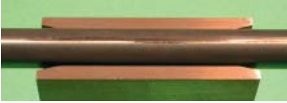
Fig.84. Exemple de gaine usée concernant le couple grappe de commande / guidage. Essai d'usure réalisé avec une gaine en acier 316L nitrurée, appuyée contre un fourreau en acier 304L sur 50 mm de longueur, avec un effort de 3N et frottant en mouvement de va-et-vient avec 128 mm par cycle, en continu, à la fréquence de 0,38 Hz, jusqu'à l'obtention d'un parcours de 63 km.
