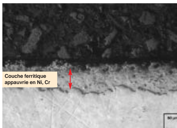
Fig. 116. Acier 316L, après immersion 3 000 h à 500 °C dans Pb-Bi, à une teneur en oxygène de 7 \cdot 10^{-8} % mass.
