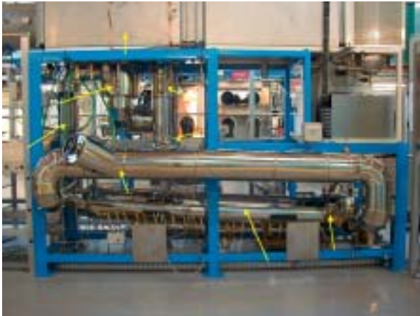
Fig. 114. Installation CICLAD pour l'étude expérimentale de la corrosion par les alliages de plomb, au département de physico-chimie (CEA Saclay).
