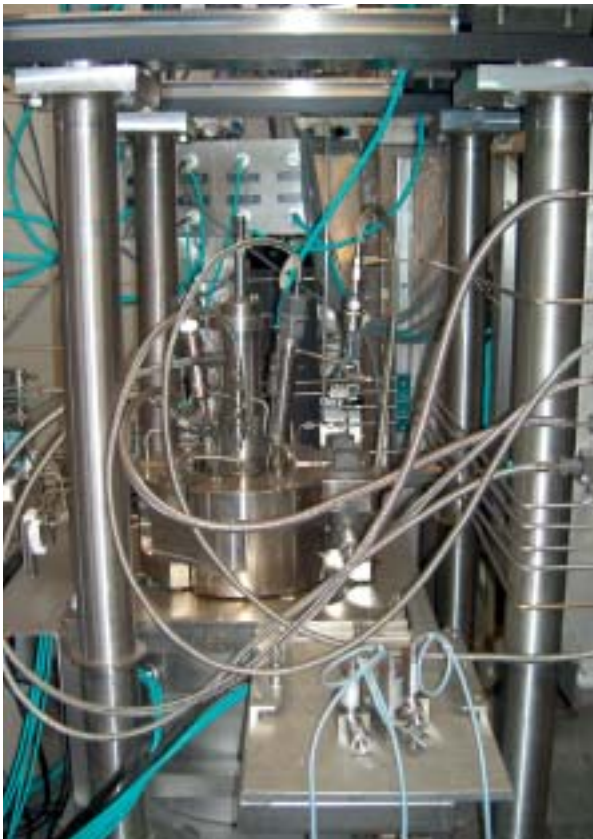
Fig. 82a. Vue de l'autoclave de traction installé en cellule blindée (CEA Saclay – DMN/SEMI).
