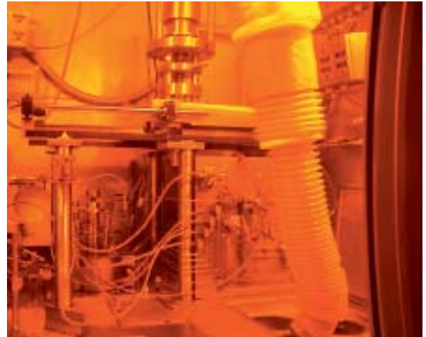
Fig. 82b. Vue de l'autoclave de traction installé en cellule blindée (CEA Saclay – DMN / SEMI).
