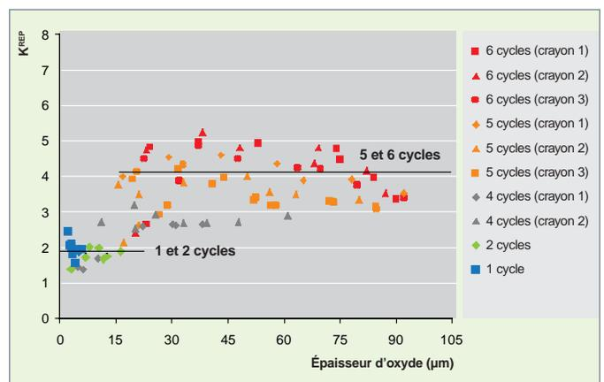
Fig. 15. Facteurs d'accélération de la corrosion dans un REP, par rapport à l'autoclave ( $K^{REP}$ ) calculés, pour le Zircaloy-4, à l'aide du code de corrosion CORCY. La forte augmentation de ce facteur au-delà de deux cycles met en évidence l'existence d'une accélération de corrosion supplémentaire pour les forts taux de combustion.
