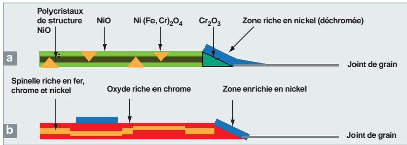
Fig. 67. Représentation schématique des oxydes contenus dans une fissure de corrosion sous contrainte formée dans une éprouvette *U-bend* en alliage 600 exposée au milieu primaire REP. a) Cas d'une fissure active d'un joint général. b) Cas d'une fissure secondaire passive [11].
