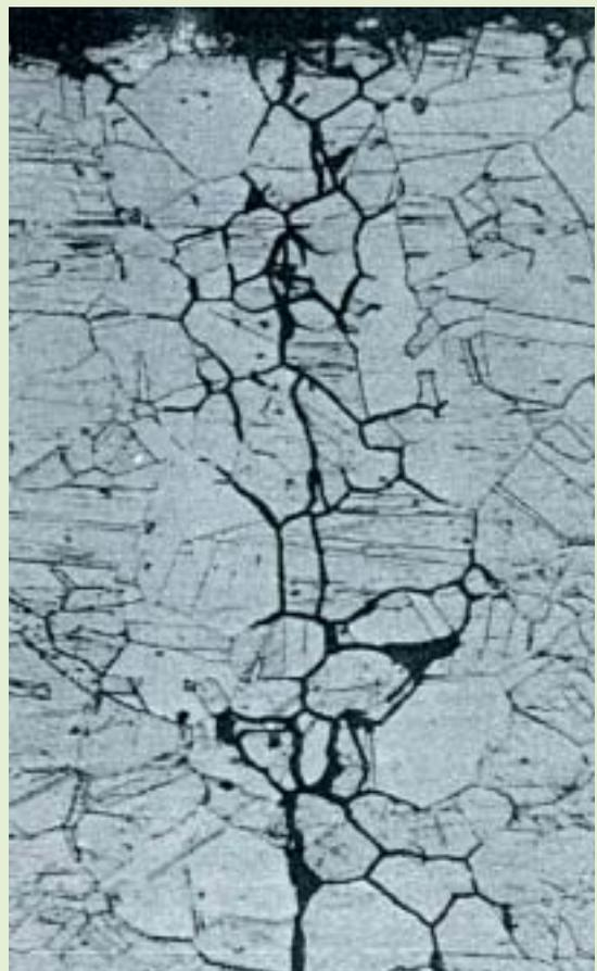
Fig. 42. Faciès de corrosion sous contrainte de l'alliage 600\* présenté au 3<sup>e</sup> congrès de métallurgie (Saclay, 1959) et observé après 90 jours en eau « pure » à 350 °C (X250).
