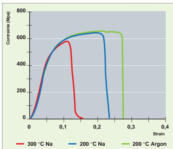
Fig. 103. Courbes contrainte-déformation d'un acier faiblement allié dans le sodium et l'argon à 200 °C et 300 °C, à 10<sup>-6</sup> s<sup>-1</sup> [3].
