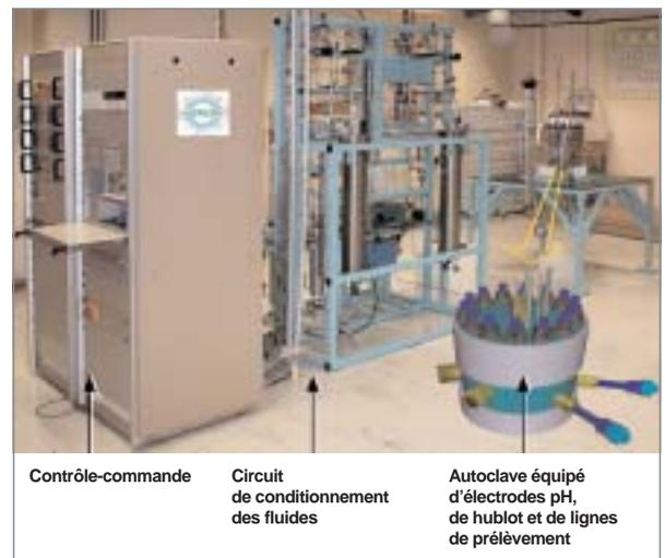
Fig. 29. L'instrument IRIS-AHT pour l'investigation de la spéciation en milieu aqueux à haute température et haute pression.
