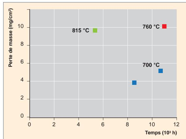
Fig. 125. Perte de masse d'échantillons en Hastelloy N placés dans trois boucles à convection forcée véhiculant un mélange de fluorures LiF/BeF<sub>2</sub>/ThF<sub>4</sub>/UF<sub>4</sub> [1].
