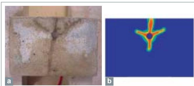
Fig. 152. Comparaison des faciès de fissuration observés et simulés.
