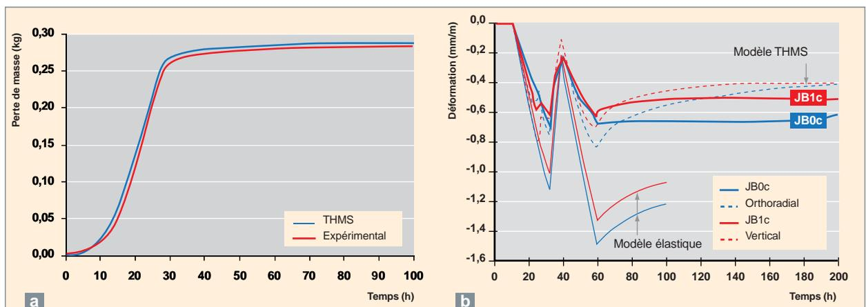
Fig. 156. Exemples d'exercices de validation du modèle thermo-hydro-mécanique simplifié (THMs) avec prise en compte de l'endommagement : a) Perte de masse d'une éprouvette en béton 16\*32 cm associée au départ de l'eau libre et à la déshydratation des phases solides [22].
