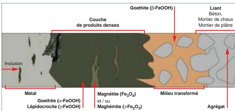
Fig. 151. Représentation schématique de l'interface métal / matériau cimentaire [12].
