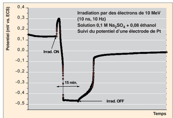
Fig. 33. Évolution avant, pendant et après irradiation du potentiel d'une électrode de platine immergée dans une solution Na<sub>2</sub>SO<sub>4</sub> 0,1 M et 0,08 M éthanol. La solution est irradiée à une fréquence de 10 Hz par des pulses d'électrons d'énergie initiale de 10 MeV, de durée 10 ns.
