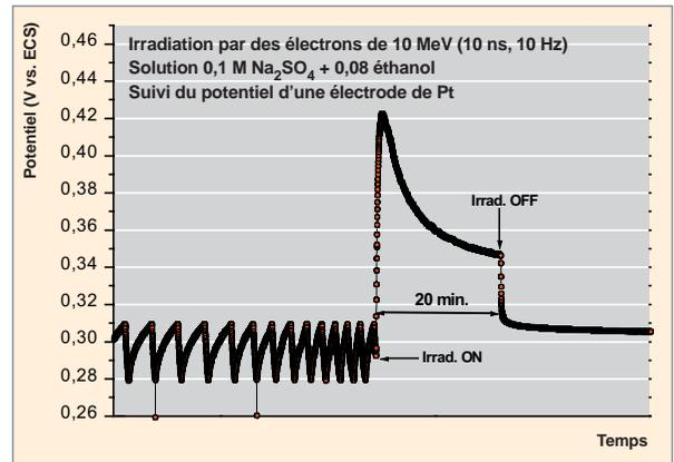
Fig. 32. Évolution avant, pendant et après irradiation du potentiel d'une électrode de platine immergée dans une solution Na<sub>2</sub>SO<sub>4</sub> 0,1 M. La solution est irradiée à une fréquence de 10 Hz par des pulses d'électrons d'énergie initiale de 10 MeV, de durée 10 ns.
