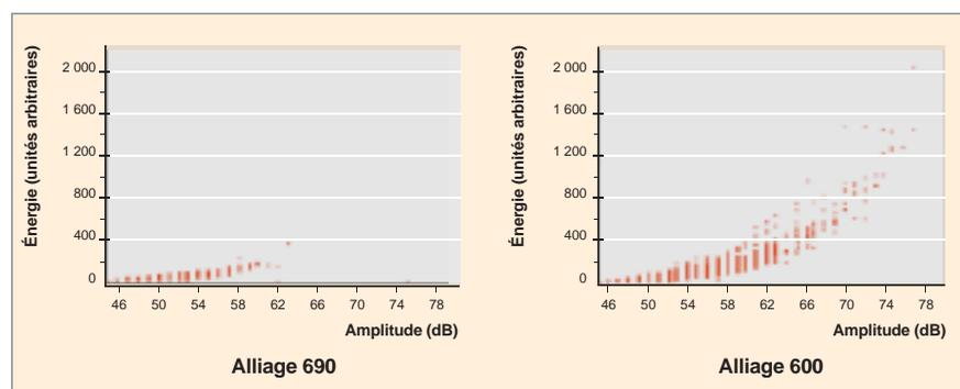
Fig. 48. Comparaison des caractéristiques énergie / amplitude (dB) des salves d'émission acoustique enregistrées avec l'alliage 690\* (pas de CSC), et avec l'alliage 600\* (CSC) lors d'un essai de traction en milieu primaire ( $K_I = 30 \text{ MPa}\sqrt{\text{m}}$ ,  $T = 330 \text{ }^\circ\text{C}$ ,  $[\text{H}_2] = 30 \text{ mL TPN}\cdot\text{kg}^{-1} \text{ H}_2\text{O}$ ) pendant 258 heures. Données non filtrées [1].
