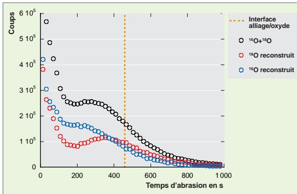
Fig. 23. Profils SIMS retraités de l'oxygène 16, de l'oxygène 18 et de l'oxygène total mesuré sur un alliage 690 corrodé 406 heures en  $H_2^{16}O$  et 144 heures en mélange  $H_2^{16}O-H_2^{18}O$  dans des conditions représentatives des REP.
