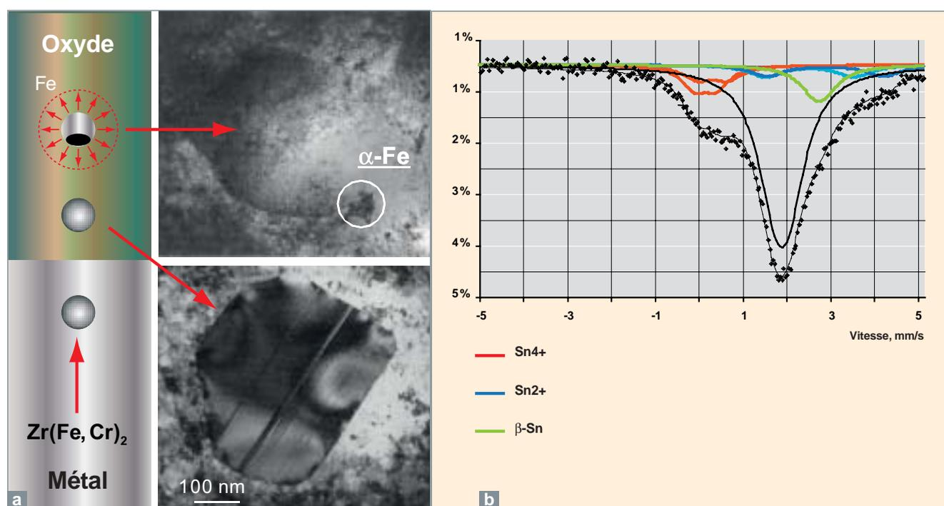
Fig. 5. Précipités de  $Zr(Fe, Cr)_2$  (a) et d'étain (b) dans une couche d'oxyde formée en autoclave sur un alliage de type Zircaloy-4 (examens réalisés respectivement en microscopie électronique en transmission et par spectroscopie Mössbauer, en mode de transmission à 77 K).
