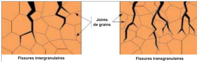
Fig. 38. Représentation schématique des fissures intergranulaires et transgranulaires.
