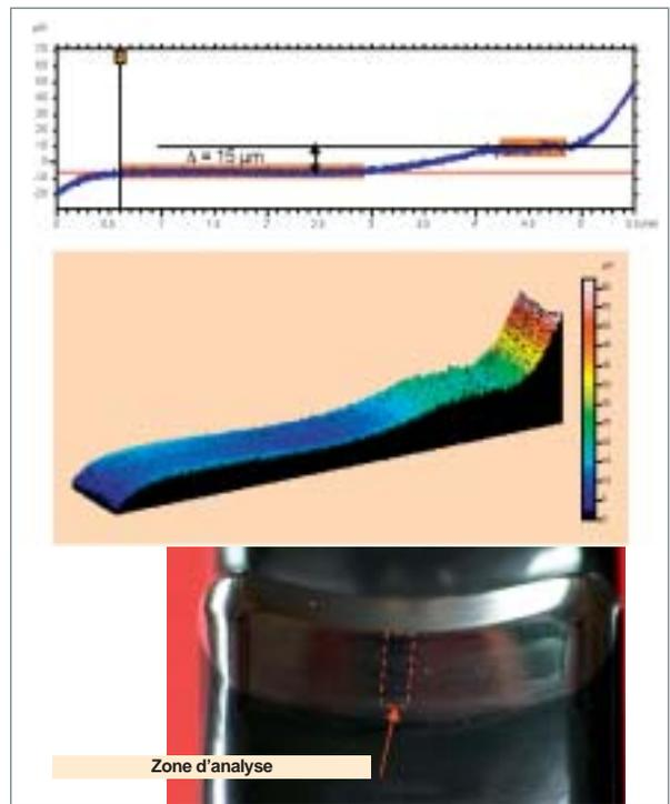
Fig. 87. Visualisations de l'usure d'une dent stellitée par microscopie confocale. Usure maximale du flanc porteur, située au centre de la zone bleutée : profondeur de 15  $\mu\text{m}$  après un mouvement de 260 000 pas à cadence lente d'un cliquet revêtu de Stellite 6 contre la tige de commande cannelée en acier Z12C13, en eau primaire à 285 °C.
