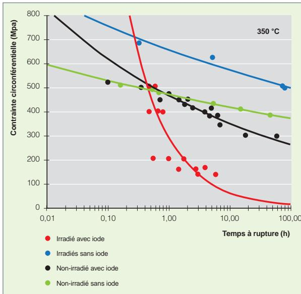
Fig. 56. Évolution du temps à rupture, en fonction de la contrainte circinérentielle pour l'alliage Zircaloy-4 irradié ou non irradié et sollicité en pression interne à 350 °C en atmosphère inerte ou en atmosphère iodée. D'après [2].
