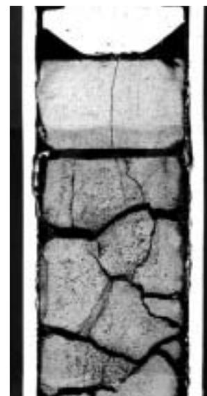
Fig. 111. Coupe métallographique axiale d'une corrosion à l'interface fissile-fertile (RIFF) sur une aiguille PHÉNIX à gaine en acier 15-15 Ti écroui irradiée à 13,3 at%, soit 115 GWj/t<sub>ox</sub>.
