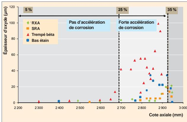
Fig. 13. Profil axial d'épaisseurs d'oxyde mesurées le long de différentes gaines en Zircaloy-4 (RxA - recristallisé, SRA - détendu, trempé  $\beta$ , bas étain), oxydées en boucle dans un environnement chimique simulant celui rencontré dans les REP (Li = 2,2 ppm, B = 1 000 ppm). Une suroxydation est notée (uniquement) pour des taux de vide supérieurs à 25%.
