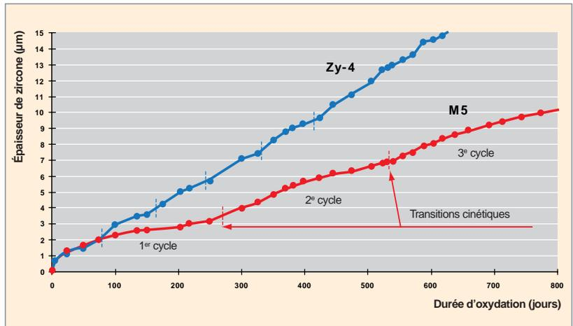
Fig. 3. Cinétiques d'oxydation du Zircaloy-4 et du M5<sup>TM</sup> déterminées à partir d'essais d'oxydation réalisés en autoclave, à 360 °C, avec 10 ppm de Li et 650 ppm de B dans l'eau. Les cinétiques apparaissent cycliques. Celle du M5<sup>TM</sup>, qui est, en moyenne, la plus lente, présente l'épaisseur de transition la plus forte.
