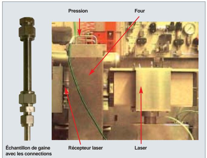
Fig. 58. Vue du nouveau dispositif d'étude de la corrosion sous contrainte par l'iode des alliages de zirconium en cellule blindée.
