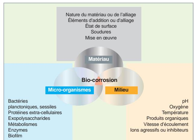
Fig. 196. Bio-corrosion : interactions matériau – milieu – micro-organismes.
