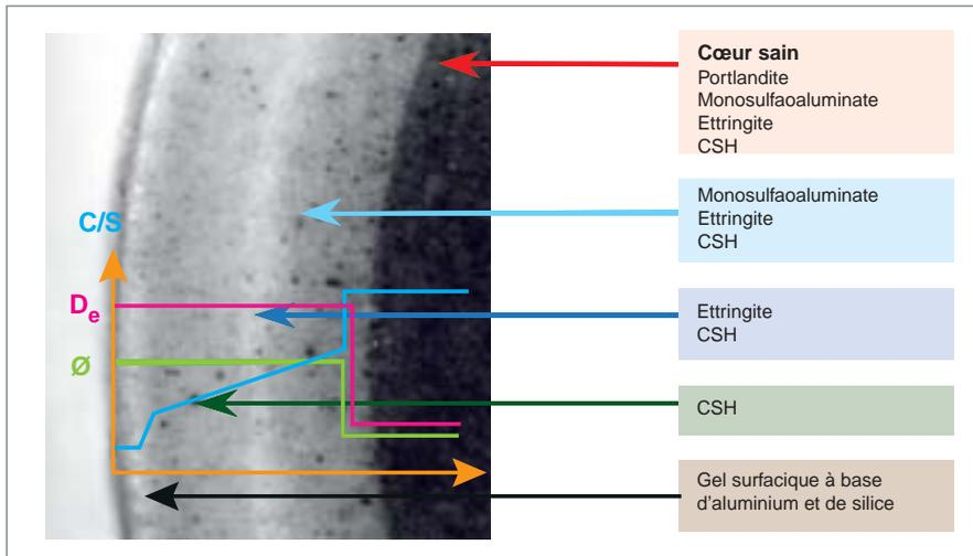
Fig. 187. Modèle phénoménologique de dégradation chimique d'un matériau cimentaire et reconstitution des paramètres physico-chimiques (C/S, rapport calcium / silice,  $D_e$  coefficient de diffusion effectif du calcium,  $\Delta$  porosité).
