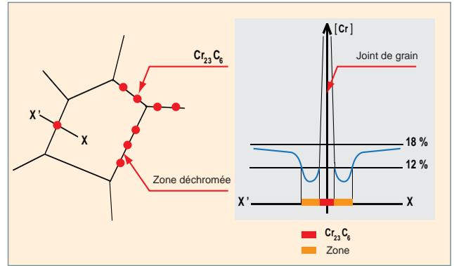
Fig. 107. L'exposition d'un acier à une température élevée dans un bain de sodium riche en carbone peut conduire à la précipitation de carbure de chrome  $Cr_{23}C_6$  aux joints de grain, d'où une sensibilisation de l'acier, qui se trouve localement déchromé.
