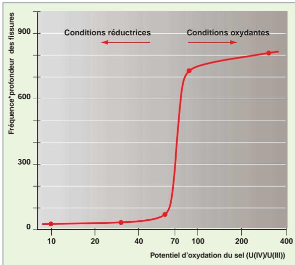
Fig. 128. Paramètre de fissuration empirique, en fonction du pouvoir oxydant estimé par le rapport  $U_{IV} / U_{III}$ . Les observations de fissures ont été réalisées sur des échantillons d'Hastelloy N immergés 200 heures dans  $LiF-BeF_2-ThF_4-U_{IV} + Te$  à  $700\text{ }^\circ C$  [3].
