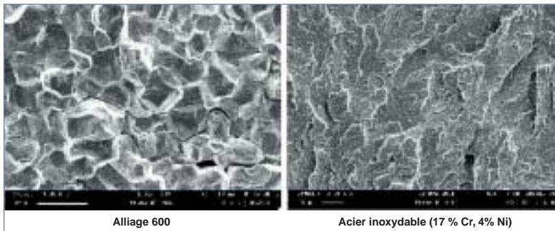
Fig. 39. Exemple de fissuration intergranulaire (Alliage 600, milieu primaire REP, 325 °C) et de fissuration transgranulaire (acier inoxydable austéno-ferritique, milieu pollué en chlorures).
