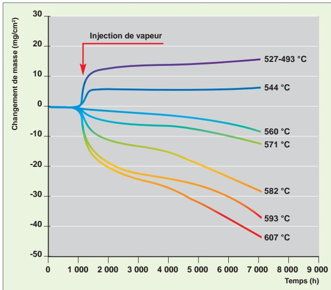
Fig. 126. Changement de masse d'échantillons en Hastelloy N placés à différentes températures dans une boucle à convection naturelle comprenant NaBF<sub>4</sub>/NaF – à t = 1 000 h de la vapeur d'eau est injectée dans le système [2].
