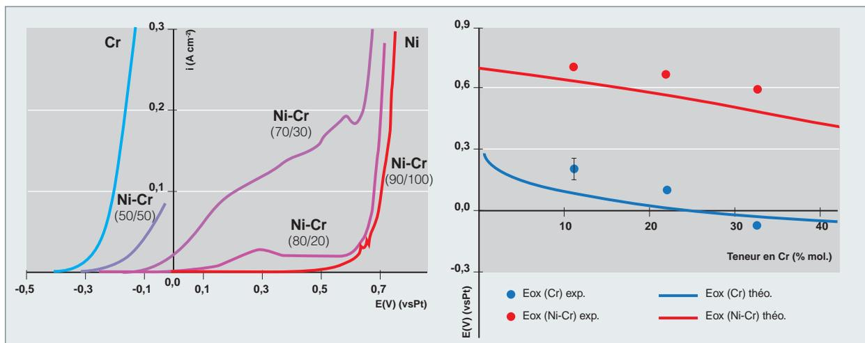
Fig. 131. Courbes de polarisation d'électrodes en chrome, nickel et alliages Ni-Cr de différentes compositions (% mass.) dans LiF-NaF à 900 °C (vitesse de balayage : 1 mV.s<sup>-1</sup>) et modélisation thermochimique associée.
