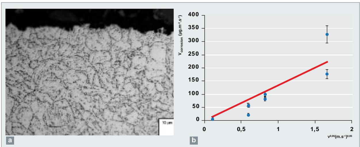
Fig. 115. a) Observation microscopique de l'acier T91 après immersion pendant 1 200 h dans l'alliage Pb-Bi à 470 °C avec une teneur en oxygène de  $10^{-11}$ - $10^{-12}$  % mass. b) Variation de la vitesse de corrosion de l'acier martensitique T91 à 470 °C, en fonction de la
