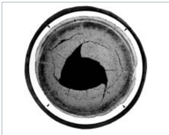
Fig. 110. Forte corrosion due à une réaction oxyde-gaine (ROG) affectant sur 360° la gaine en acier 15-15 Ti écroui d'une aiguille PHÉNIX irradiée à très fort taux de combustion (17,2 at% soit 146 GWj/t<sub>ox</sub>) - Arrachement d'un fragment de combustible au centre, lors de la préparation de l'échantillon.
