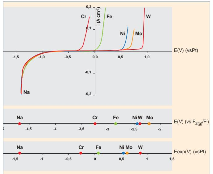
Fig. 130. Courbes de polarisation d'électrodes en chrome, fer, nickel, molybdène et tungstène dans le sel fluoré ( $LiF-NaF$ ) à  $900\text{ }^\circ C$  et comparaison des échelles de potentiels d'oxydation thermochimiques et expérimentaux.
