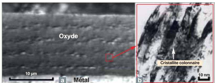
Fig. 4. Film d'oxyde formé sur le M5<sup>TM</sup> en autoclave (360 °C, 10 ppm Li, 650 ppm B) : a) examen en microscopie électronique à balayage montrant la stratification de l'oxyde ; b) examen en microscopie électronique en transmission montrant des cristallites de zirconite ayant une bonne cohésion entre elles.
