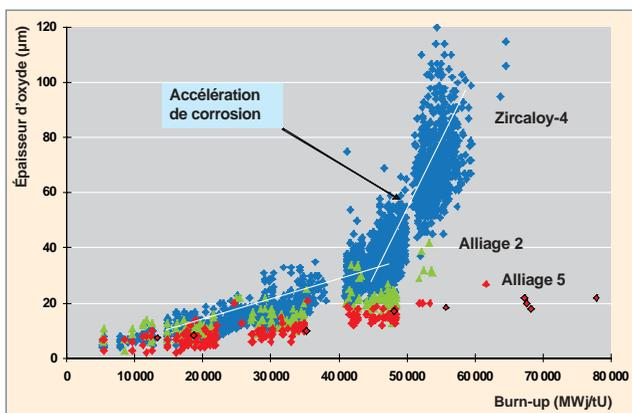
Fig. 14. Épaisseurs d'oxyde mesurées par courants de Foucault, sur site et en laboratoire chaud, sur des gaines de crayons combustibles en Zircaloy-4 (1,3 % Sn), M5<sup>TM</sup> (alliage 5) et alliage 2 (0,5 % Sn) issues de réacteurs à eau sous pression (données Areva-NP et CEA).
