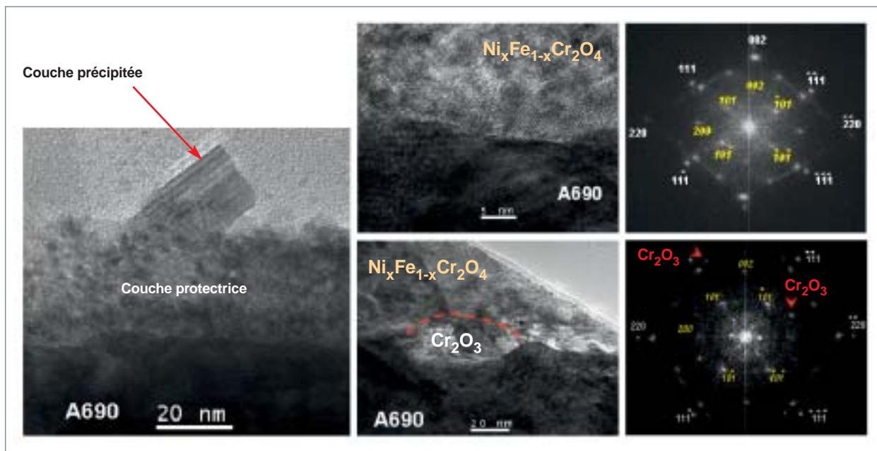
Fig. 21. Observation par MET, MET haute résolution et diffraction locale de la couche d'oxyde formée sur un alliage 690 corrodé 858 h en milieu primaire des REP (325 °C, 1 000 ppm de bore sous forme  $H_3BO_3$  avec 2 ppm de lithium sous forme de LiOH, soit un pH de 7,2 à 325 °C, une concentration en hydrogène dissous de l'ordre de  $1,7 \times 10^{-3} \text{ mol.L}^{-1}$ ). Observations réalisées par M. SENNOUR (ENSMP).
