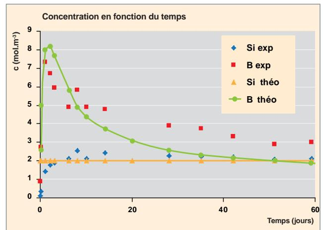
Fig. 172. Évolution temporelle des concentrations en bore et en silicium libérées en solution par une poudre de verre R7T7 possédant un rapport surface de verre / volume de réacteur de  $1,2 \cdot 10^5 \text{ m}^{-1}$ , et pour un taux de renouvellement de l'eau de  $4,4 \cdot 10^{-11} \text{ m.s}^{-1}$ . Les incertitudes sur les données expérimentales sont de l'ordre de 20 %.
